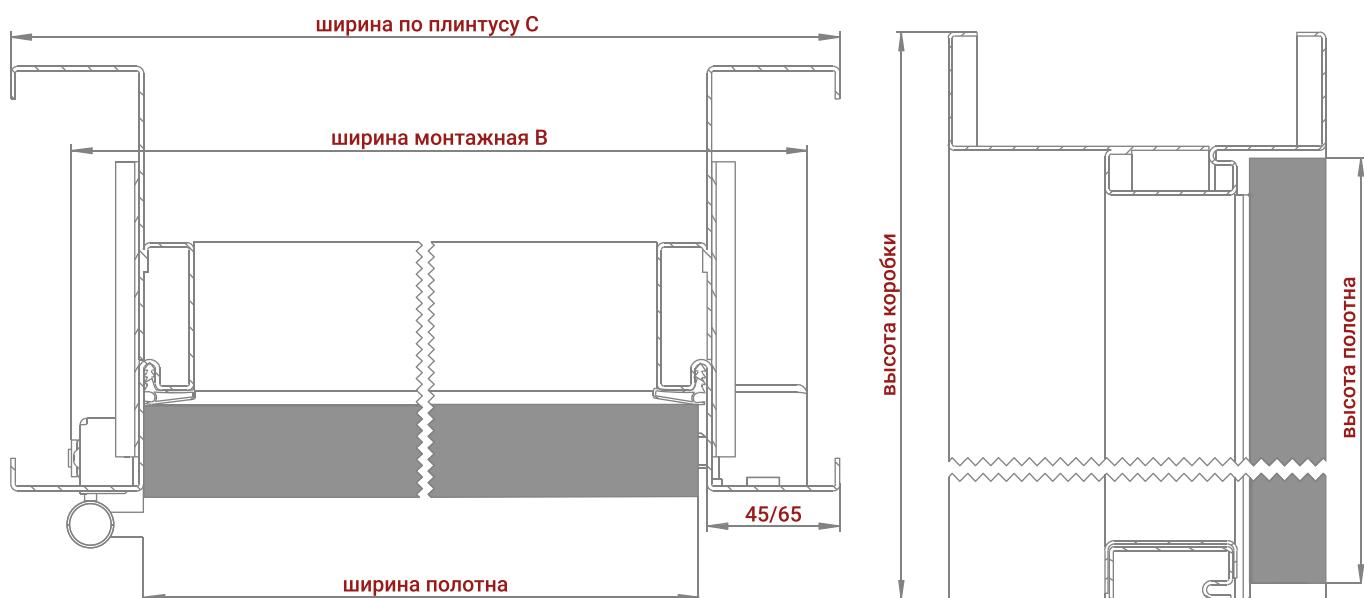
Габаритные размеры комбинированных блоков (коробка стальная, полотно деревянное)
